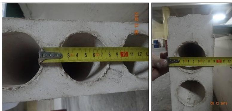
Рис.1.2. Толщина стенок по горизонтали и вертикали
